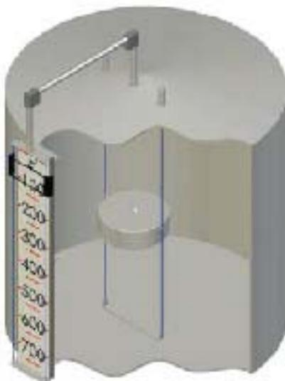
**Corte de tanque con detalle de funcionamiento Escala Invertida.**
